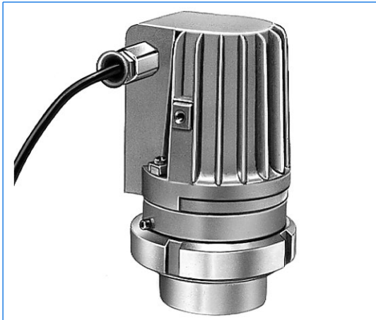
Typ FKEL 20 dH R, Ex d IIC T4 Gb, Ex t IIIC T130°C Db IP67, Ex II 2 G + D, 230 V, 20 W, Halogenausführung, auf Schraub-Schauglasarmatur ähnlich DIN 11851, DN 65, PN 6. Befestigung über Einsteckbördel «R».
