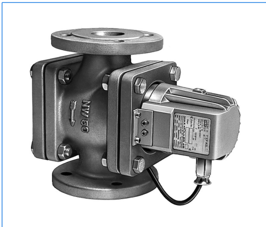
Typ FKEL 5 dH WM, Ex d IIC T6 Gb, Ex t IIIC T80°C Db IP67, Ex II 2 G + D, 230 V, 5 W, mit Opalglas «M» auf Durchfluss-Schauglasarmatur NW 50.
